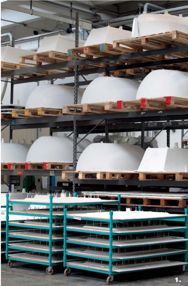
1. Produzione dei semilavorati in Duralight® mediante Cold Cure, e mediante termoformatura di lastre
